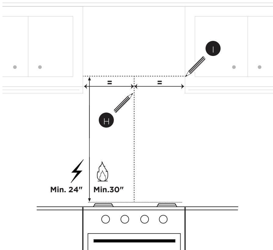
**MIN. 24" OVER ELECTRIC/MIN. 30" OVER GAS**
